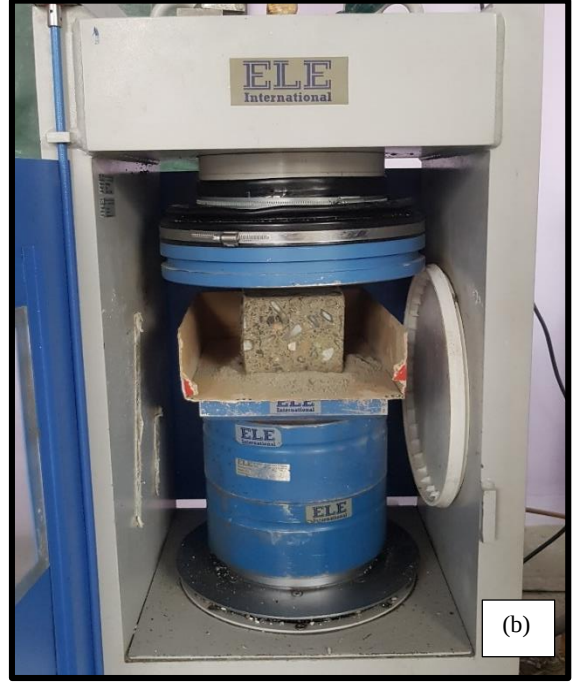
Şekil 4.14 (a) Mustafapaşa mahallesindeki yıkılan bir binadan alınan numune, (b) Basınç dayanımı testi.
