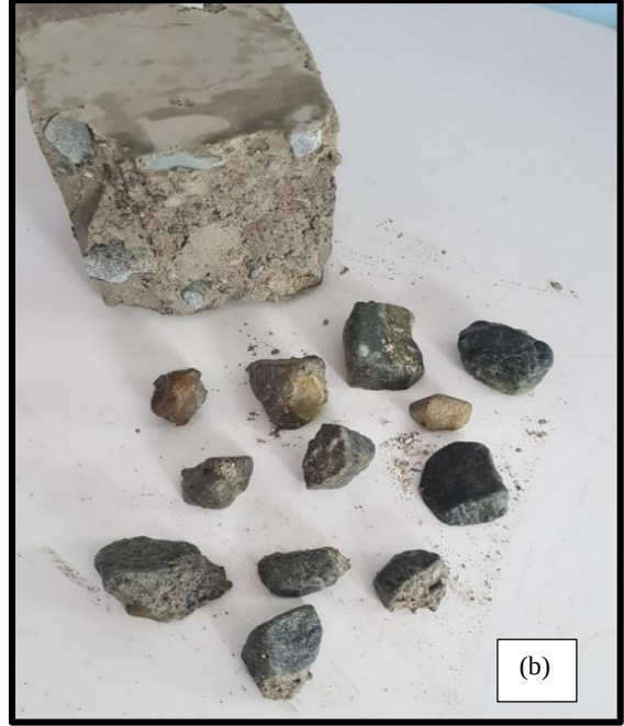
Şekil 4.15 (a) Basınç deneyi sonucunda dağılmış numune, (b) Dağılan numunelerin içinden elle sökülmüş agrega örnekleri.
