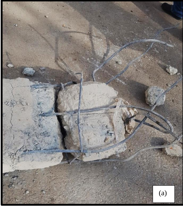
Şekil 4.14 (a) Mustafapaşa mahallesindeki yıkılan bir binadan alınan numune, (b) Basınç dayanımı testi.
