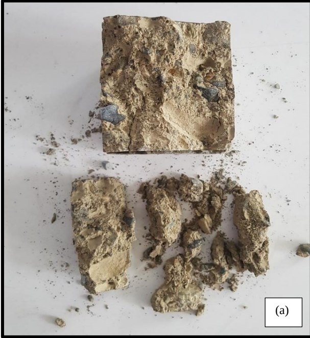
Şekil 4.15 (a) Basınç deneyi sonucunda dağılmış numune, (b) Dağılan numunelerin içinden elle sökülmüş agrega örnekleri.
